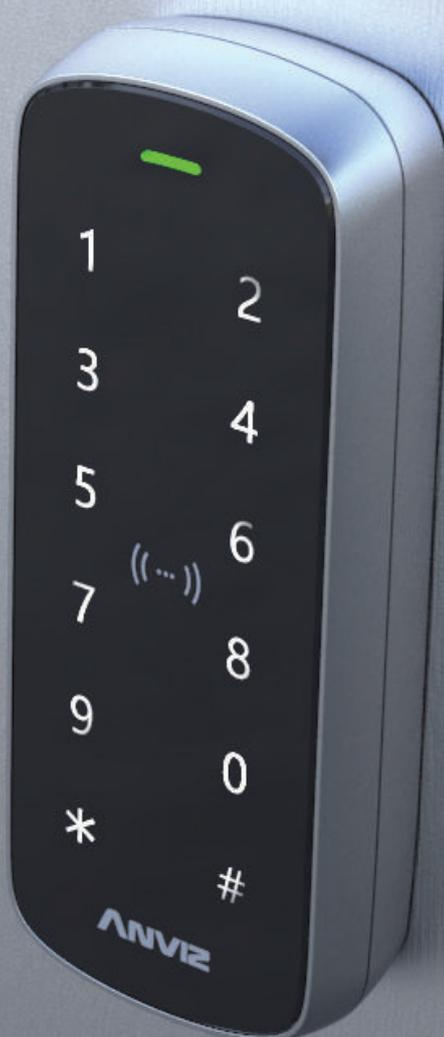
M3 Pro — это компактное устройство контроля доступа в металлическом корпусе со степенью защиты IP65, подходящее для использования вне помещений. Поддерживает карты Mifare 13,56 МГц и двухчастотный модуль EM-карт 125 кГц. Сенсорная клавиатура с подсветкой, поддержка протоколов TCP/IP и RS485 удобна для использования. M3 Pro оснащён встроенным реле для прямого запираения и стандартным выходом Wiegand, что позволяет использовать его как автономный контроллер доступа и считыватель RFID.
