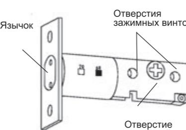
Зазор, это расстояние от края до центра отверстия в передней части двери. По умолчанию, он равен 2 3/8" (60мм).
