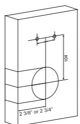
Подберите расстояние в 2 3/8" или 2 3/4" (60мм или 70мм) от края и разместите центр отверстия на передней части двери, также два отверстия для крепления корпуса замка.
