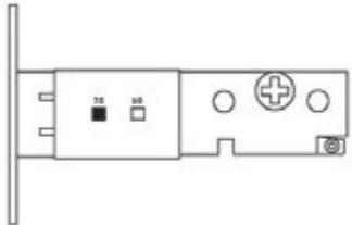
Зазор в позиции 2 3/4" (70мм)
