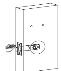
1) Введите ригель в отверстие и удерживайте его параллельно полотну двери. Отметьте контур пластины и снимите его.
