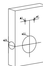
Просверлите 2 1/12" (53мм) отверстие в передней части двери и 1 1/4" (26мм) отверстие для ригеля в торце двери, а также два отверстия 5/16" (7мм) для шурупов.
