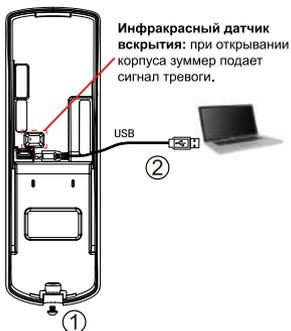
**Инфракрасный датчик вскрытия:** при открытии корпуса зуммер подает сигнал тревоги.
